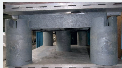
La stabilità della struttura dopo 48 ore con un carico di 60 ton/m 2
